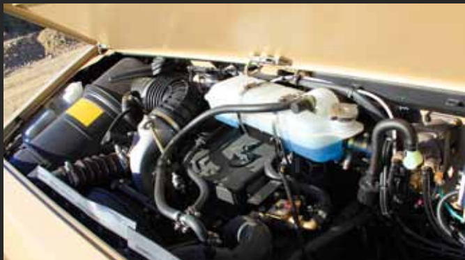
▲ Bewährt: 218 PS leistet das 4,8 Liter große Vierzylinder-Aggregat, das auf der ganzen Welt seinen Dienst tut.
