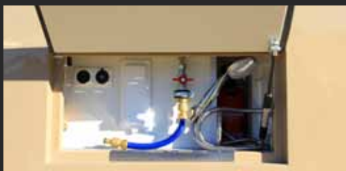
◀ Quelle der Erfrischung: An der rechten Seite findet sich eine zusätzliche Außendusche.
